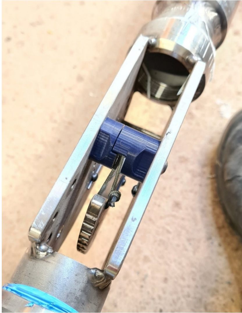
Fig. 3-7: Hole Lock ist per wasserlöslichen Pin gespannt, 10:10 Uhr
