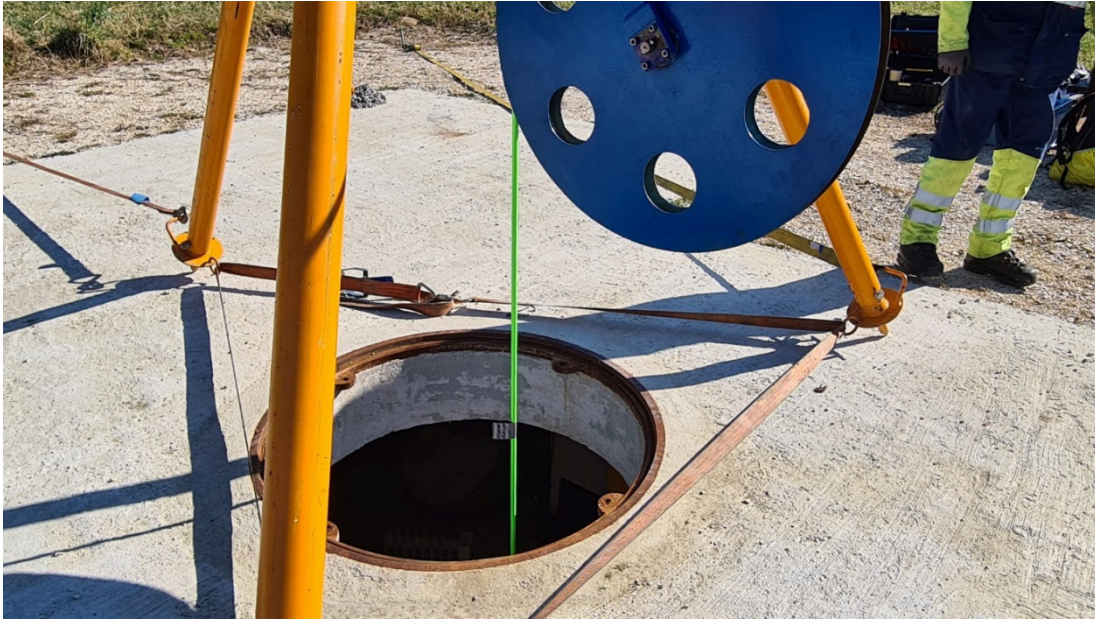
Fig. 3-11: Seismometer ist auf Teufe. Markierung 939 m ist auf GOK, 11:35 Uhr
