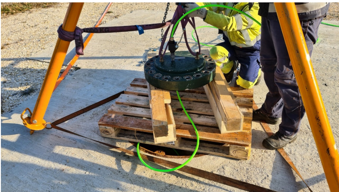
Fig. 3-14: Flansch mit durchgefädeltm Seismometerkabel vor dem Herablassen, 9:00 Uhr
