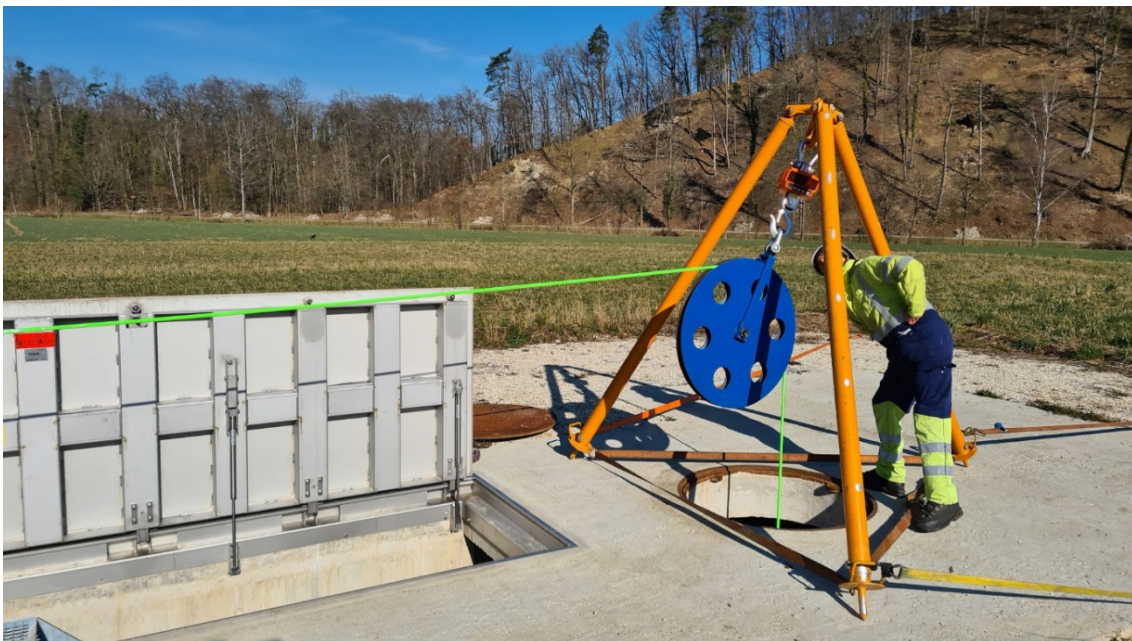
Fig. 3-9: Das Einfahren des Seismometers wird per Kranwaage überwacht, 10:28 Uhr
