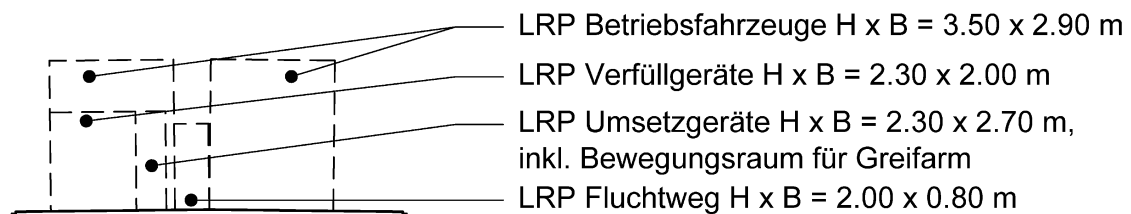
Fig. B-5: LRP des Einstellraums Betriebsfahrzeuge mit Vorbeifahrt im ZB (nicht massstäblich)
