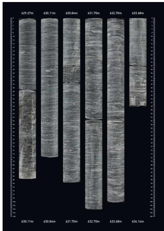
Fig. 3-9: Kernbeispiel des Opalinustons aus MAR1-1
