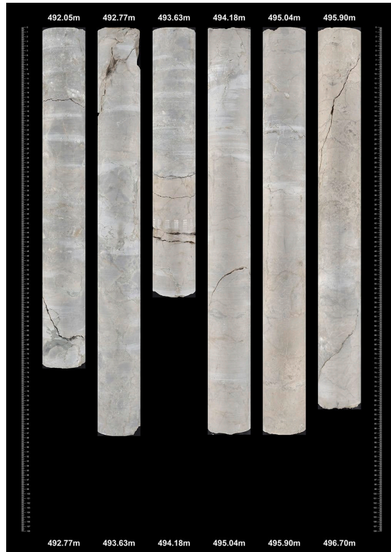
Fig. 3-4: Kernbeispiele aus STA3-1 der «Felsenkalk» + «Massenkalk»
