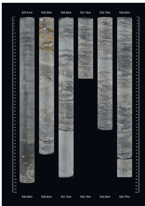
Fig. 3-5: Kernbeispiel des Opalinuston aus BOZ1-1
