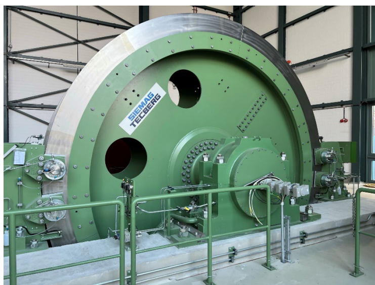
Fig. 6-5: Fördermaschine der neuen Schachtförderanlage bei Schacht Konrad
