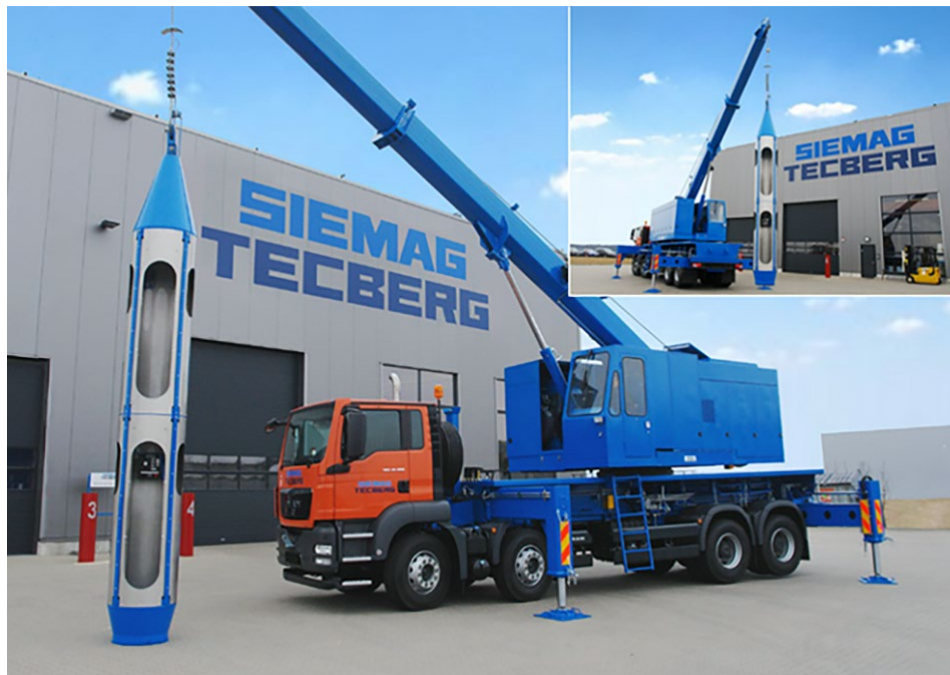
Fig. 5-1: Mobile Schachtwinde in Arbeitsposition
