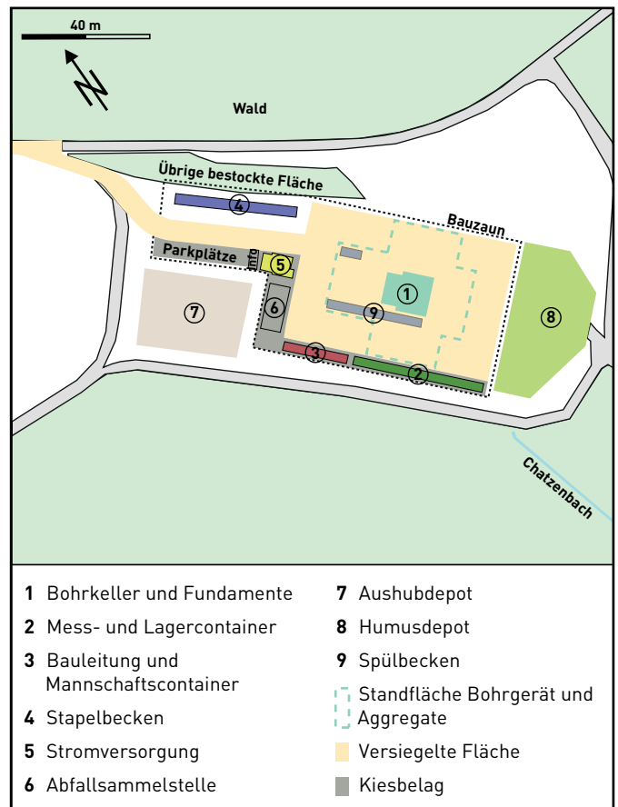
Auslegung Bohrplatz Uhwiesen
