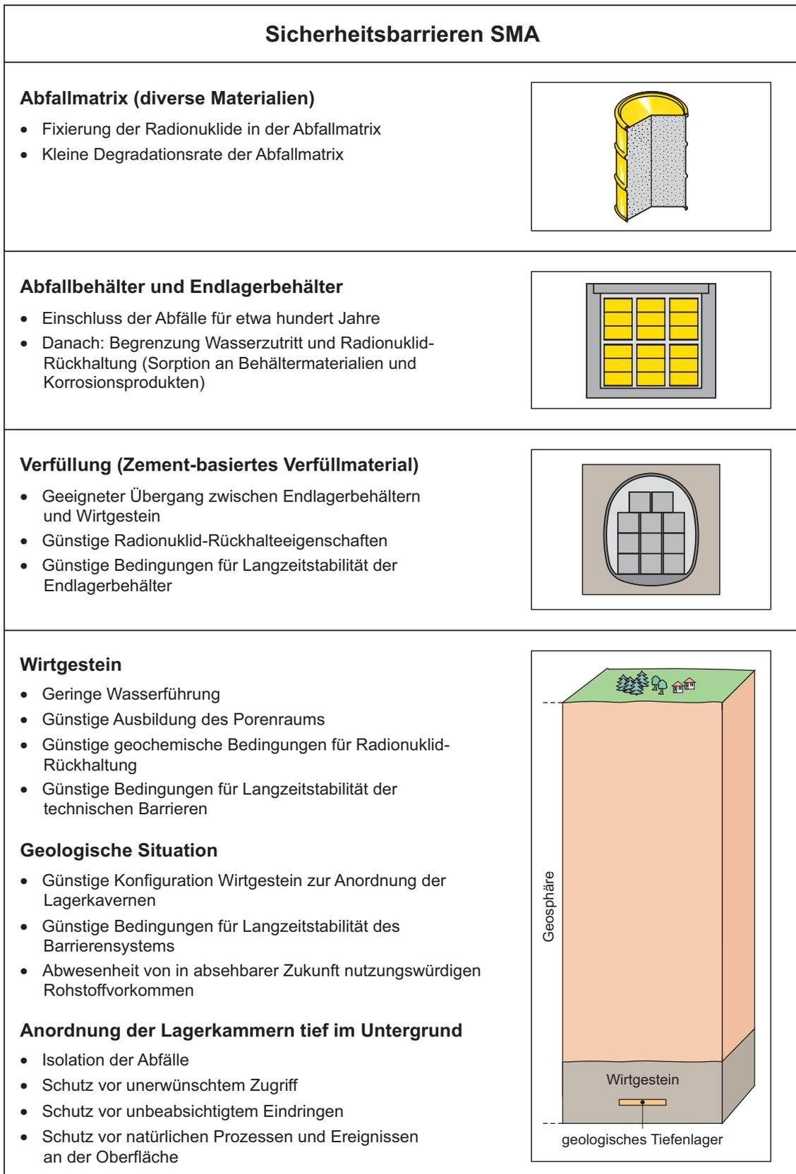
Fig. 3-1d: Sicherheitskonzept für das SMA-Lager mit gestaffelten passiven Sicherheitsbarrieren.
