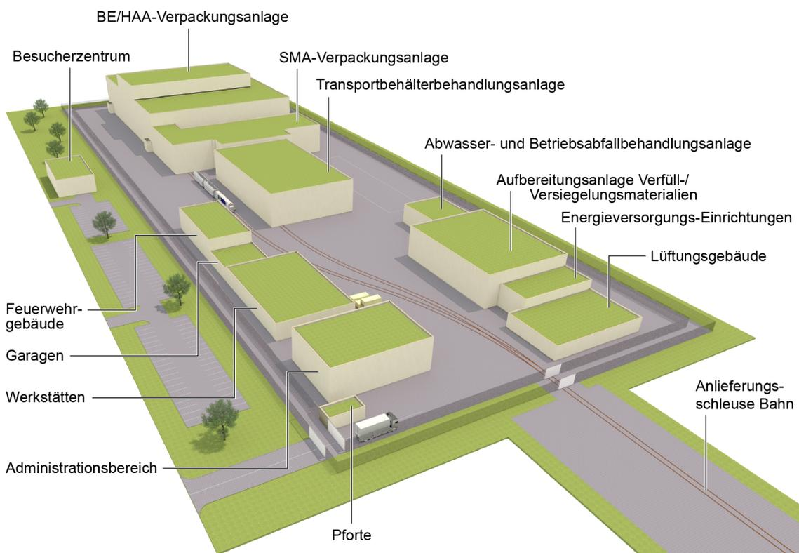
Fig. 3-3: Beispielhafte Anordnung und Ausgestaltung der funktional erforderlichen Bauwerke der Oberflächenanlage für ein Kombilager.
