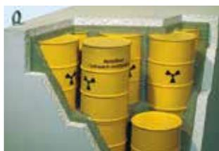
SMA-Fässer in Endlagercontainer einzementiert oder verpackt
