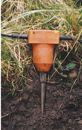
Hochempfindliche Geophone werden in den Boden gesteckt und zeichnen dort die Schwingungen auf. Foto: Nagra
