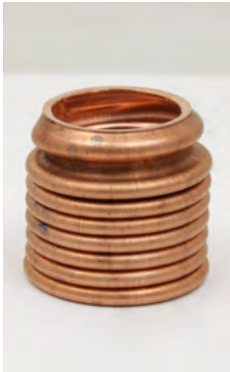
Oben: Verschiedene Prototypen von Bridge Plugs, die in ein Bohrloch eingebracht werden. Dort verhindern sie den Fluss von Gasen und Flüssigkeiten in der Längsrichtung des Bohrlochs.
