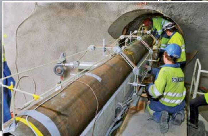
Arbeiten im Rahmen des 1:1-Einlagerungsversuchs zur Untersuchung des Stollenumfelds (FE).
