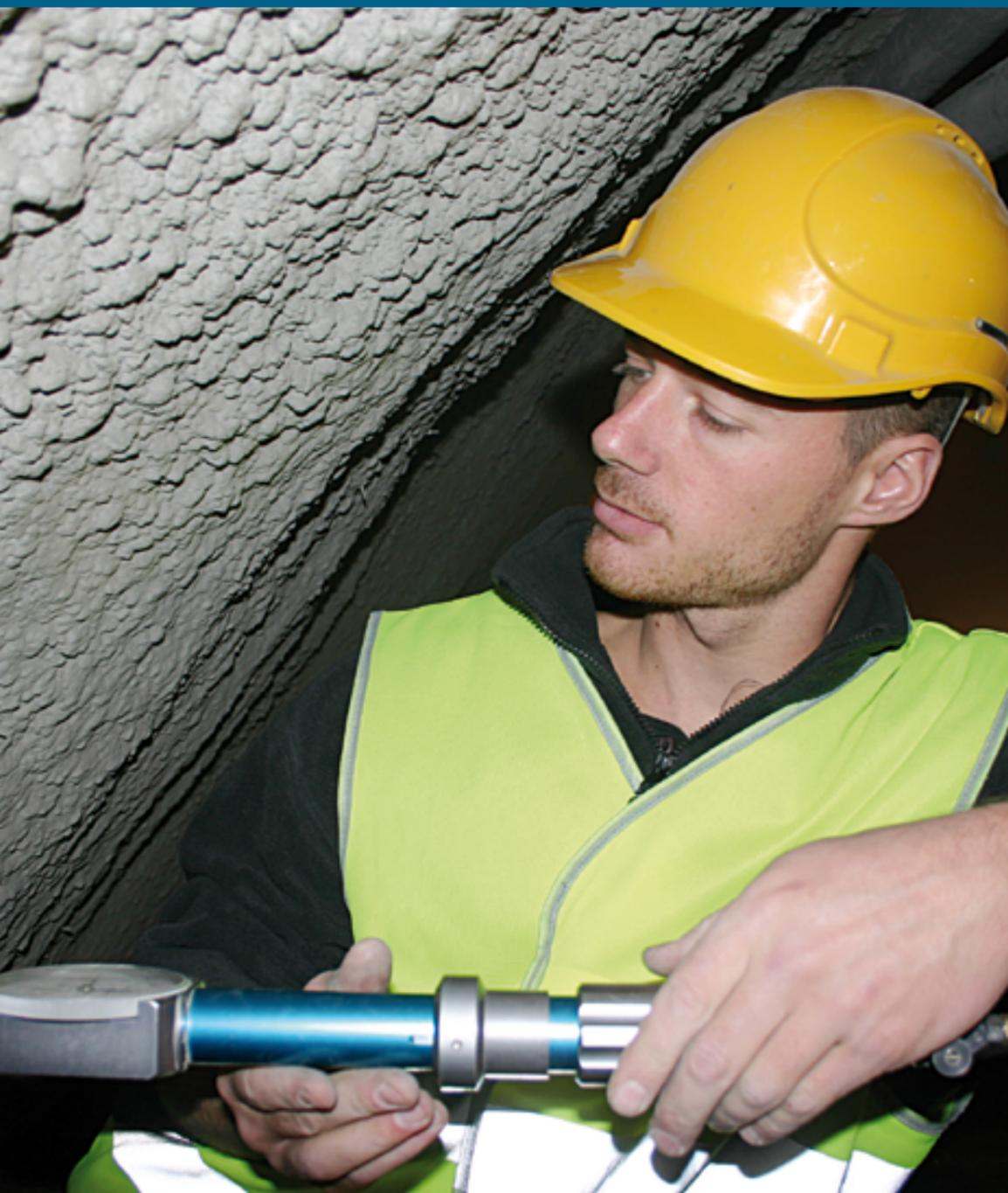
Die Nagra ist seit über zehn Jahren an Untersuchungen im Felslabor Mont Terri beteiligt. Im Bild Messung von Deformationen im Opalinuston nach Ausbruchsarbeiten.
